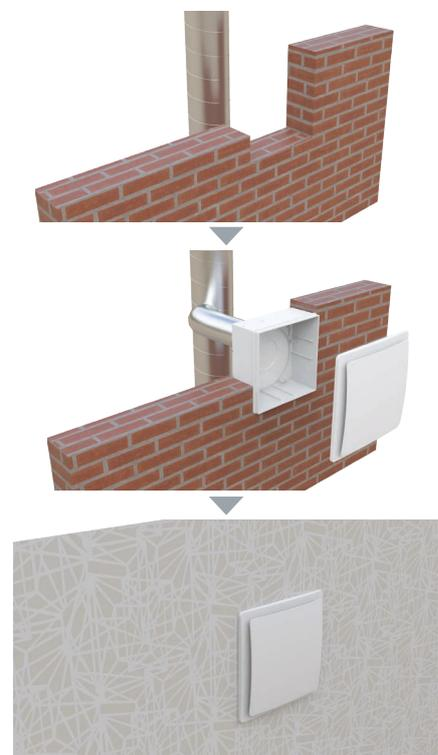
Das Ventilatorgehäuse wird während der Bauarbeiten montiert. Die elektrische Verkabelung zum Anschluss der Ventilatoreinheit VNV-1A(E) 80 wird durch eine spezielle Öffnung im Gehäuse herausgeführt.
