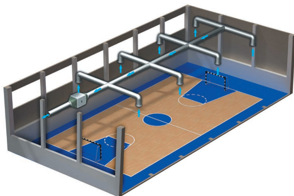
Einsatzbeispiel von Ventilator VS im Fitnessraum
