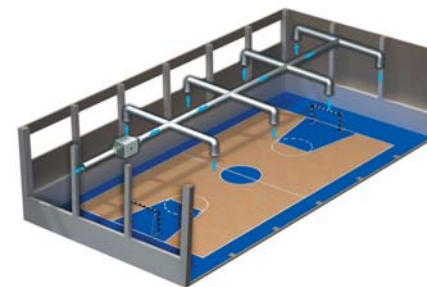
Einsatzbeispiel von Ventilator VS im Fitnessraum
