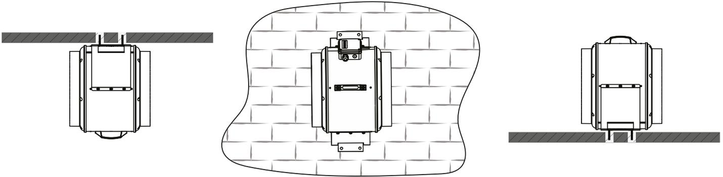
Verbinden Sie die Lüftungsrohre mit entsprechendem Durchmesser mit dem Ventilator (Anschlüsse müssen luftdicht sein).
