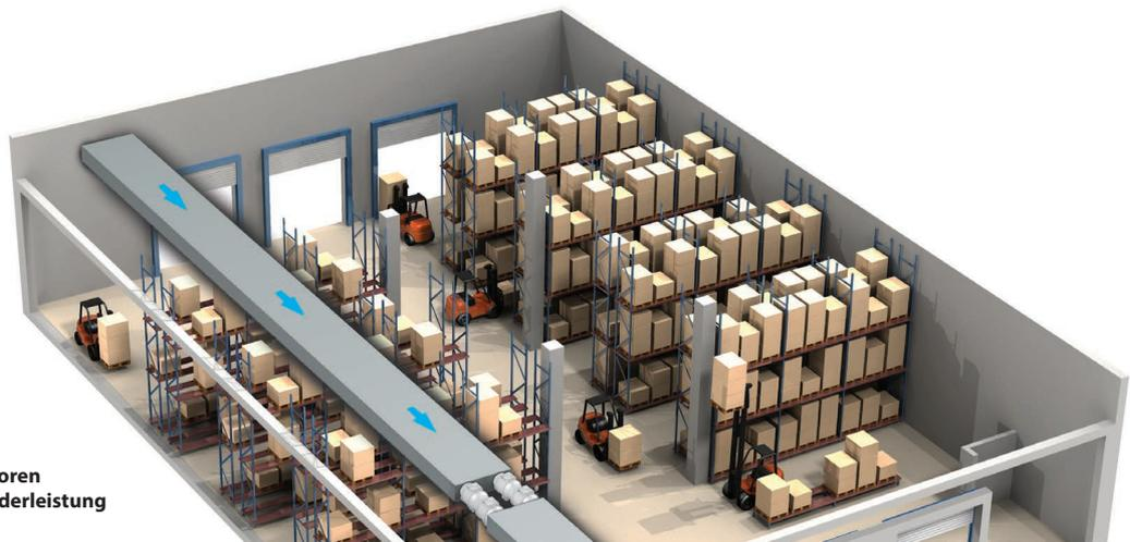
Parallele Montage der Ventilatoren
