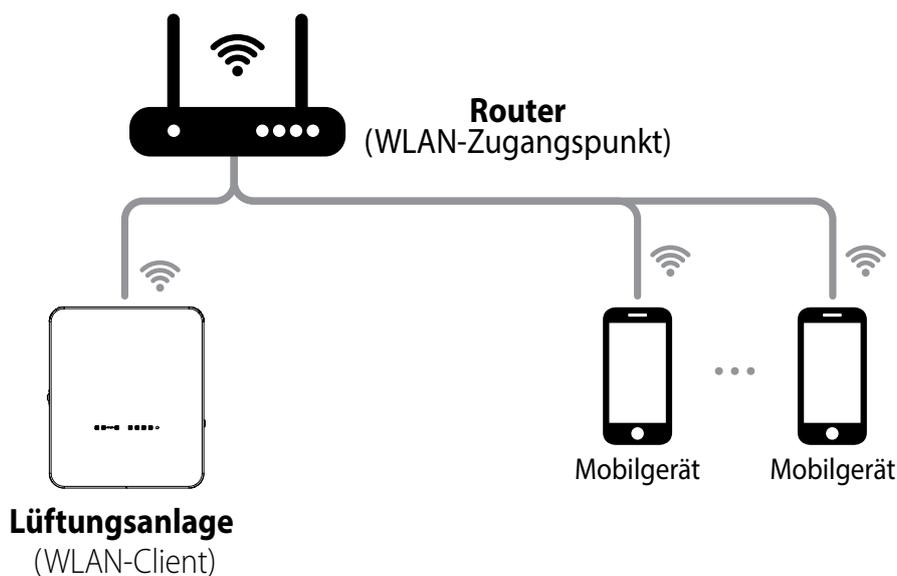
**Beispiel 3:** Schema des direkten Anschlusses des Smart Home-Systems mit einem Router, an den mehrere WLAN-Zugangspunkte angeschlossen sind.
