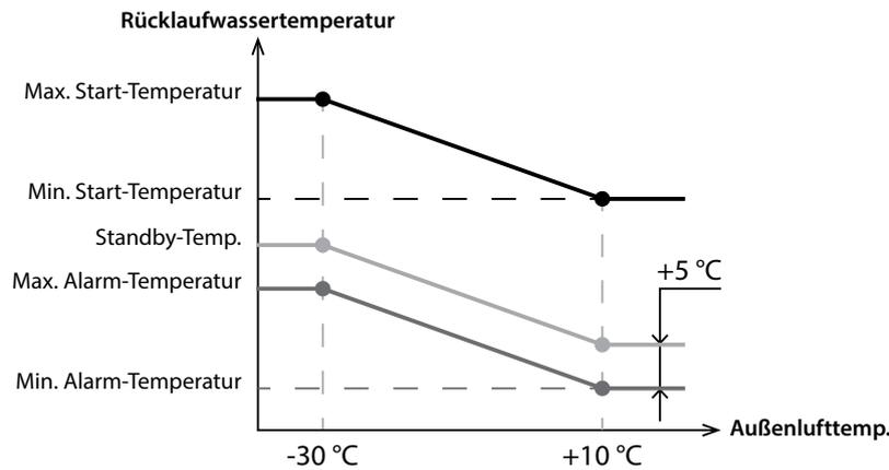
**Typ der Kälteanlage.** Auswahl der Steuerlogik der Kälteanlage Wenn der diskrete Typ ausgewählt ist, wird die Kälteanlage über ein Relais gesteuert. Wenn der Analogtyp ausgewählt ist, wird die Kälteanlage mit einem 0-10 V-Signal und einem Auslöserelais gesteuert. Sowohl die diskreten als auch die analogen Optionen ermöglichen die Auswahl des Steuermodus der Kälteanlage und die Einstellung der Minimalen Ein/Ausschaltzeit der Kälteanlage.
