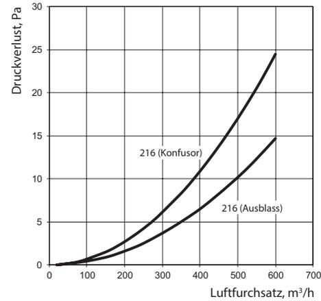
Mehrstufige Reduzierung für Rundrohre
