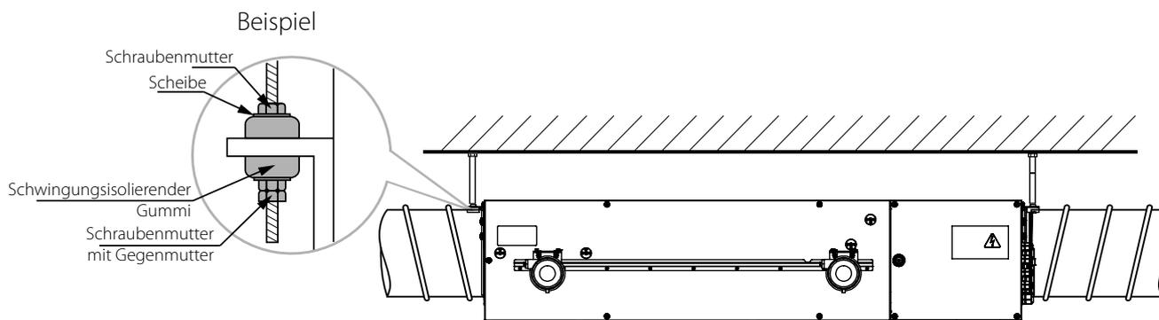
Um eine optimale Leistung zu erreichen und den Luftwiderstand, der infolge von Turbulenzen im Luftstrom entsteht, zu minimieren, verbinden Sie ein gerades Luftrohrstück mit den Anschlüssen an beiden Seiten der Anlage.
