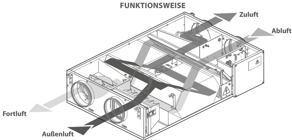
Die Anlage ist mit einseitig saugenden Zu- und Abluft-Radialventilatoren mit rückwärts gekrümmten Schaufeln, wartungsfreien EC-Motoren mit Außenläufer und mit einem eingebautem Überhitzungsschutz, einem Platten-Gegenstromwärmetauscher sowie einem Elektro-Heizregister ausgestattet.
