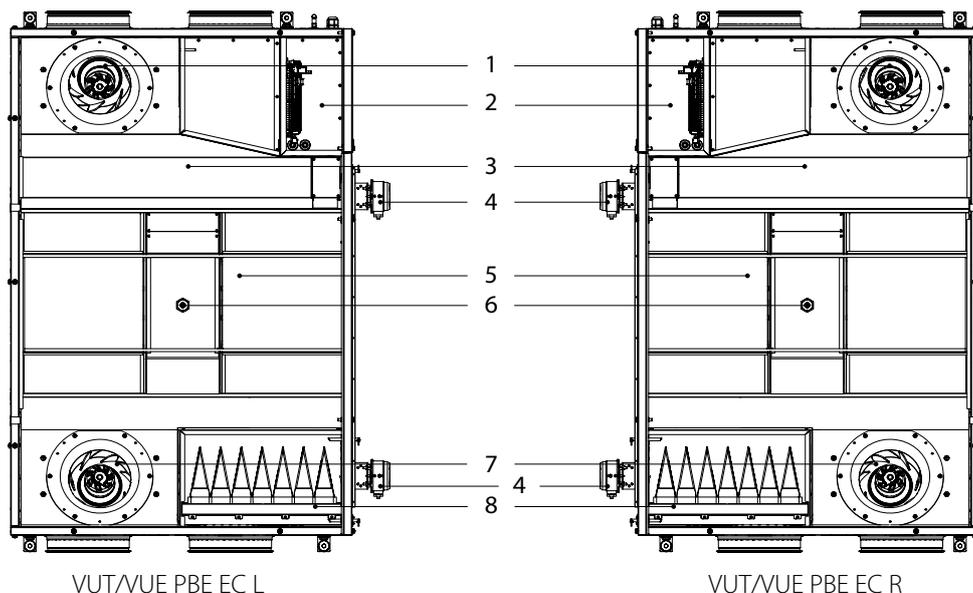
1. Zuluftventilator; 2. Steuereinheit; 3. Abluftfilter; 4. Differenzdruckschalter; 5. Wärmetauscher; 6. Bypass; 7. Abluftventilator; 8. Zuluftfilter.
