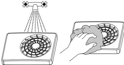
2. Nehmen Sie die Frontabdeckung ab. Reinigen Sie die Laufradschaufeln des Ventilators mit einem weichen, trockenen Tuch oder Pinsel.
