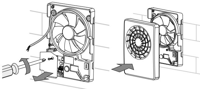
6. Montieren Sie den Ventilator mit Hilfe der Schrauben.
