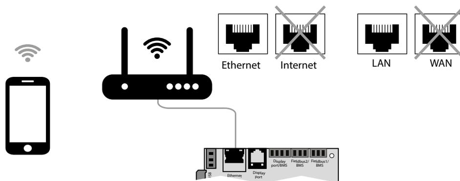
Die Lüftungsanlage kann über ein Mobilgerät oder Tablet gesteuert werden. Den Router mit Hilfe eines Netzkabels (mindestens Cat5, RJ45) über den Ethernet-Port (LAN) an die Steuereinheit anschließen. Das Menü des Routers aufrufen und die IP-Adresse der Lüftungsanlage finden. Die IP-Adresse in der URL-Leiste in einem Mobilgerät eingeben. Danach ist die Lüftungsanlage für die Steuerung der Lüftungsanlage mit einem Mobilgerät bereit.
