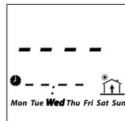
Um die Zeitspanne OFF auf dem Bedienfeld th-Tune einzustellen, drehen Sie den minimalen Sollwert bis OFF nach unten, wie in der Abbildung unten gezeigt.
