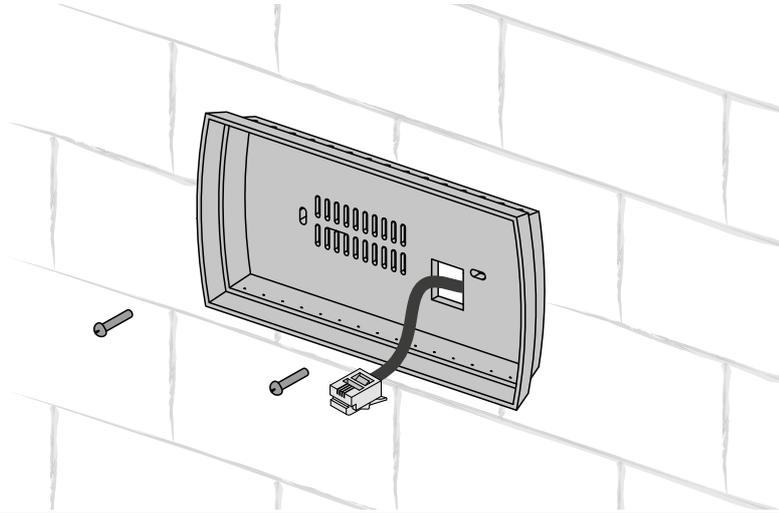
2. Schließen Sie das Telefonkabel an die Abdeckung des Bedienfeldes an. Befestigen Sie die Abdeckung des Bedienfeldes mit den mitgelieferten Senkkopfschrauben an der Rückseite des Gehäuses, wie unten dargestellt. Drücken Sie vorsichtig auf die Vorderseite des Bedienfeldes bis es einrastet. Hiermit ist die Montage abgeschlossen.
