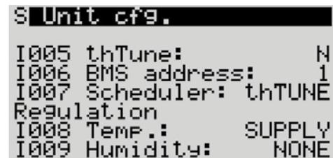
Wenn die Steuerung über **BMS** erfolgt, muss der Parameter **I005 Enable thTune management** auf 0 gesetzt werden.
