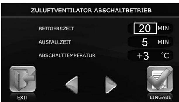
• Ist der Menüpunkt **ZULUFTVENTILATOR ABSCHALTBETRIEB** auf **EIN** gesetzt, so schaltet die Steuerung in die Einstellung **ZULUFTVENTILATOR ABSCHALTBETRIEB** um.
