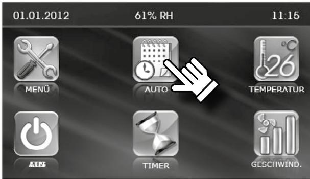
• **AUTO** -Betrieb ermöglicht einen planmäßigen, zeitgesteuerten Betrieb. Die Lüftungsanlage läuft mit der eingestellten Geschwindigkeit, bei eingestellter Lufttemperatur, in den eingestellten Zeiträumen. Die Lüftungsanlage wechselt zwischen den eingestellten Zeitintervallen in den **Standby-Modus**.
