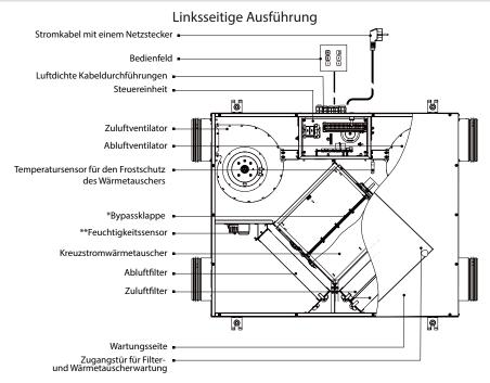
Die Wartungsblende der Anlage ist mit einer abnehmbaren Zugangstür für Reinigung und Austausch von Filter und Wärmetauscher ausgestattet. Die Steuereinheit befindet sich im Gehäuse der Anlage.
