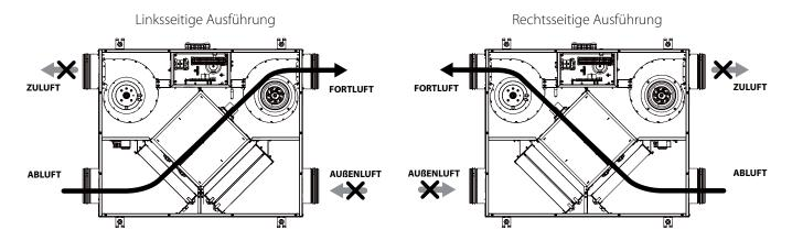
**Sommerbetrieb**: Bei Anlagen mit einer Bypassklappe kommt der Teil der abgeführten Luft nicht in Verbindung mit dem Wärmetauscher.
