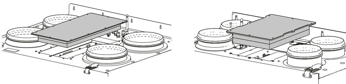
Führen Sie die Kabel zur Steuereinheit durch die Kabeldurchführungen in der Anlage. Führen Sie die elektrischen Anschlüsse gemäß dem Anschlussschema durch.
