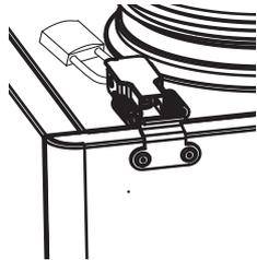
**NACH DER MONTAGE DES GERÄTS SPEREN SIE DEN VERSCHLUSS, UM EIN VERSEHENTLICHES ÖFFNEN DES DECKELS ZU VERHINDERN.**
