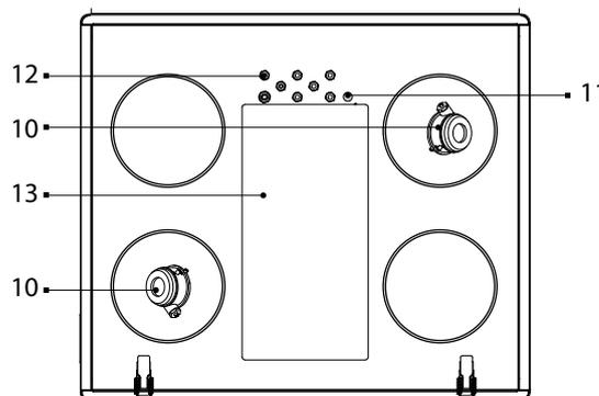
1: Steuereinheit 2: Bypassklappe (außer VUT/VUE 160 V(1)) 3: Gegenstrom-Wärmetauscher 4: Abluftfilter 5: Zuluftfilter 6: Zuluftventilator 7: Abluftventilator 8: Auffangwanne 9: Abluftstutzen 10: Differenzdruckschalter (nur für die Anlagen VUT/VUE 550 VB EC A21) 11: SETUP MODE Taste (für die Anlagen mit Steuerung A21) 12: luftdichte Kabeldurchführungen 13: Deckel der Steuereinheit
