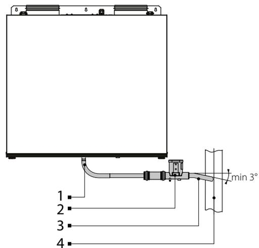
1: Ablaufstutzen 2: Siphon 3: Anschlussrohr 4: Abwassersystem
