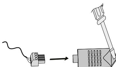
Befestigen Sie den Sensor mit der Schraube am Gewindeniet. Verbinden Sie den Sensorstecker mit dem Stecker mit dem Kabel vor Steuereinheit.
