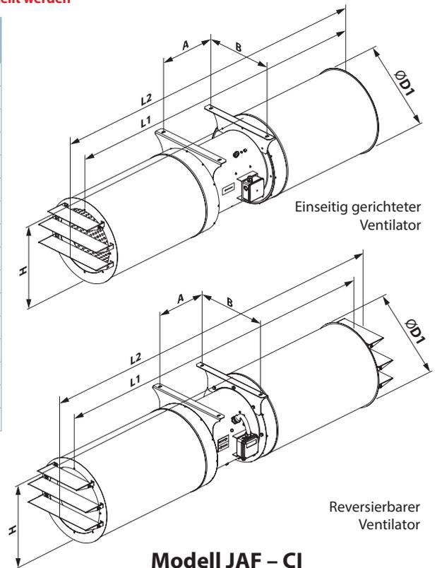
Ventilatoren mit einer Feuerwiderstandsklasse von 200 ° C/2 Stunden können separat bestellt werden
