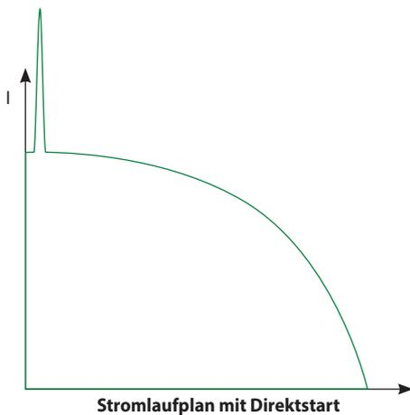
Standard-Schaltgeräte (Leitungsschutzschalter, Schütze und Starter) sind nicht für längere Überlastungen ausgelegt, so dass der Ventilator beim Start automatisch ausschaltet.
