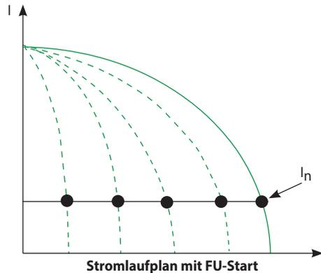
Während des Startens erhöht der FU die Frequenz von 0 Hz auf die Netzfrequenz (50 oder 60 Hz). Wenn die Frequenz allmählich erhöht wird, kann davon ausgegangen werden, dass der Motor bei einem vorgegebenen Frequenzwert auf seiner Nennzahl läuft. Außerdem läuft der Motor auf seiner Nennzahl, das Nenndrehmoment ist sofort verfügbar und der Strom entspricht ungefähr dem Nennwert.
