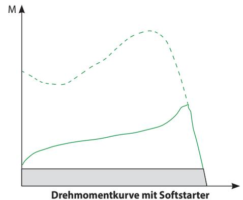
Die sehr niedrige Spannung, die dem Motor beim Start ursprünglich zugeführt wird, verhindert plötzliche Stöße. Sowohl Spannung als auch Drehmoment nehmen allmählich zu.
