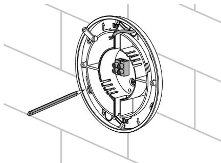
Bringen Sie das Stromkabel zur Lüftungsöffnung, bohren Sie die Befestigungslöcher und setzen Sie die Dübel ein.
