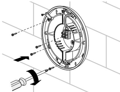
Schließen Sie den Ventilator gemäß Anschlussschema an die Stromversorgung an. Bringen Sie die Abdeckung an, indem Sie sie im Uhrzeigersinn drehen. Schrauben Sie die Befestigungsschraube ein.
