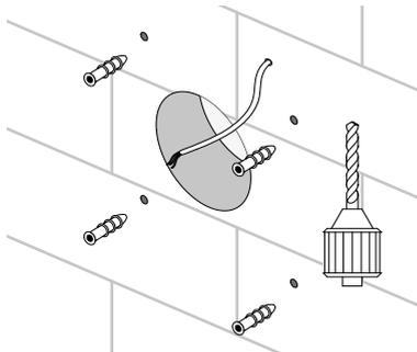
Befestigen Sie den Ventilator mit den Schrauben.
