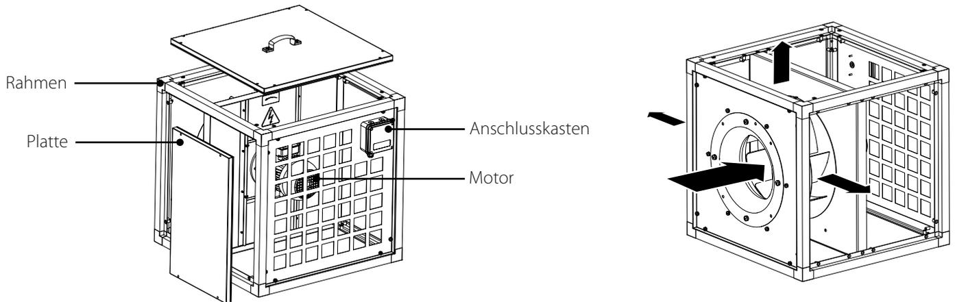
Beim Anschluss des Ventilators an das System der Lüftungsrohre wird empfohlen, das in der Betriebsanleitung aufgeführte Zubehör zu verwenden.
