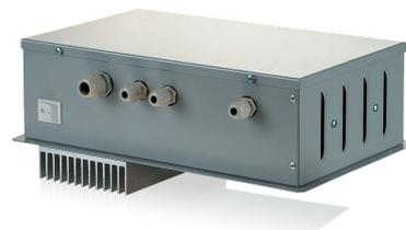
Der Algorithmus der Temperaturregelung des Luftstromes besteht in der Regelung der Einschalt-/Ausschaltzeit (volle Leistung) gemäß den Heizverhältnissen. Die Steuereinheit überwacht die Drehzahl der Ventilatoren, unterbricht die Stromversorgung des Heizregisters im Falle des Ausfalls des Ventilators bzw. beim Geschwindigkeitsabfall des Luftstromes.
