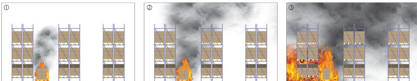
Brand in einem Gebäude mit einem Entrauchungssystem
