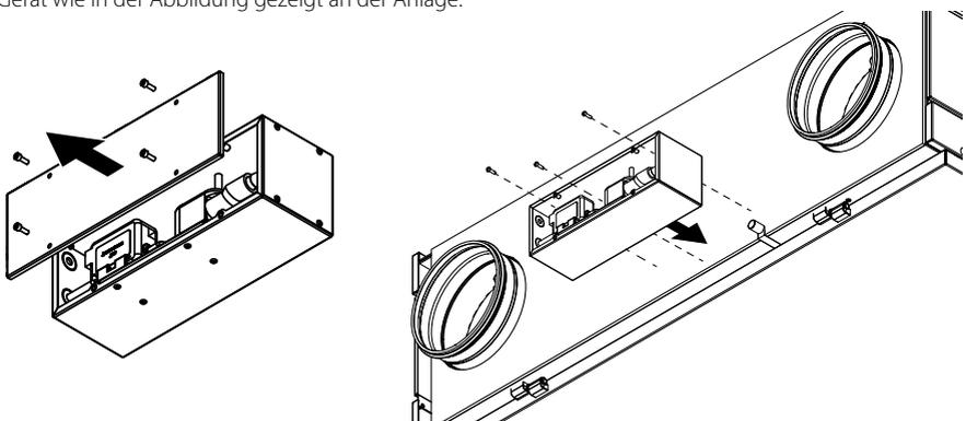
Die Entwässerungspumpe wird gemäß der Betriebsanleitung der Entwässerungspumpe über die Kabeldurchführungen des Geräts an die Stromversorgung und an das Abwassersystem angeschlossen.
