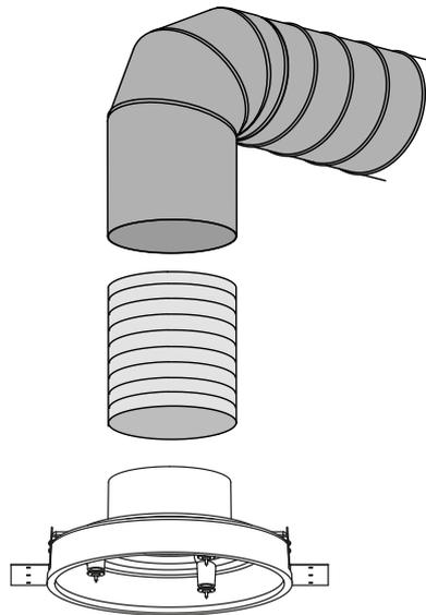
**Benutzen Sie selbstschneidende Schrauben mit einem Durchmesser von mindestens 3,9 mm, um die Montagehalterungen an der Trockenbauwand zu befestigen.**
