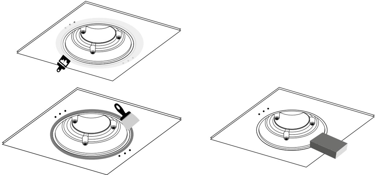
Entstauben der Oberflächen und Schlitzte. Grundierung auftragen («Knauf Tiefengrund» o. ä.).
