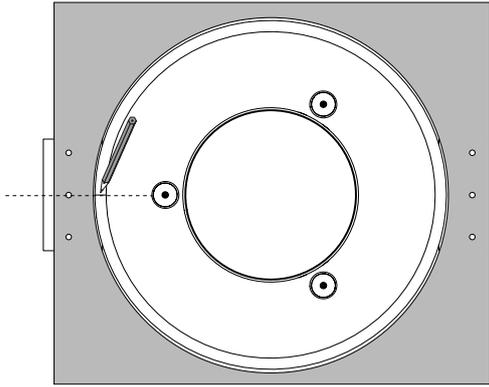
Für eine bequeme Montage ist die Montageschablone auf der inneren Verpackungsbelegung zu positionieren. Richten Sie die Schablone am Diffusor aus und machen Sie eine Markierung koaxial zum Loch in der Mitte.
