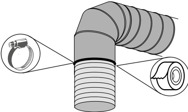
Verbinden Sie das flexible Lüftungsrohr mit dem starren Lüftungsrohr. Befestigen Sie die Verbindung mit der Schneckengewindeschelle.
