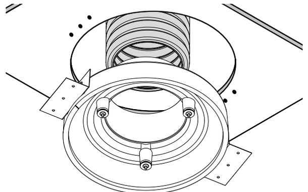
Montieren Sie das Lüftungsrohr auf den Flansch des Diffusors.
