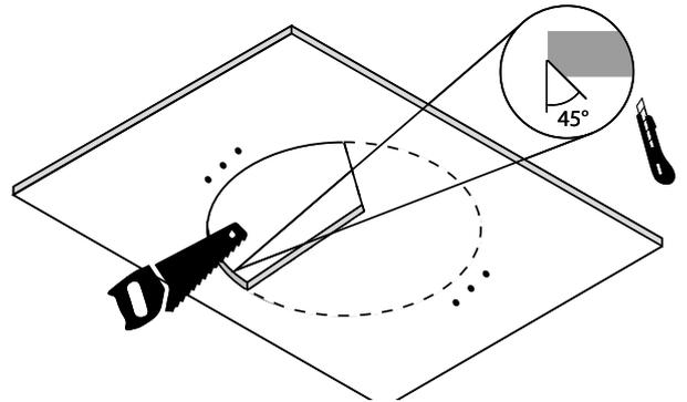
Richten Sie die Schablone an der Decke aus und markieren Sie die Stellen, an denen der Diffusor montiert werden soll, und machen Sie Löcher für die Montage. Bohren Sie ein Loch in die Trockenbauwand. Entfernen Sie die Fase in einem 45°-Winkel bis zu 1/3 der Trockenbauwanddicke.
