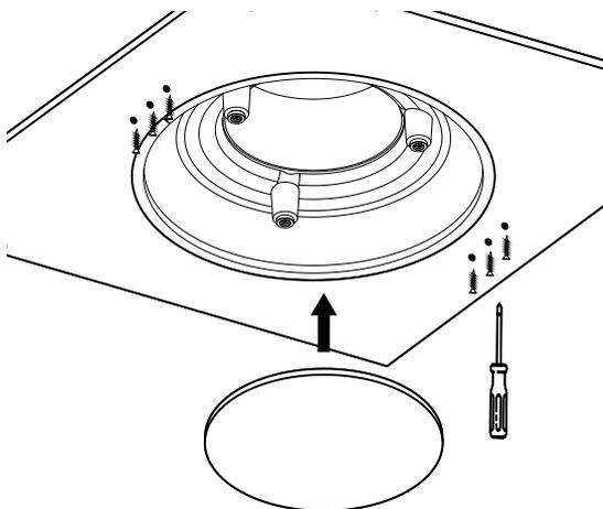
Befestigen Sie den Diffusor mit Schrauben. Montieren Sie die mit Magnethaltern befestigte Frontplatte.
