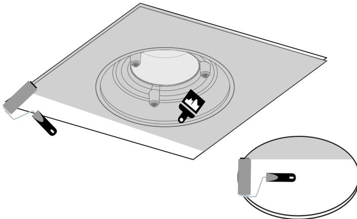
Die Grundierung auftragen (die vom Hersteller der Farbe empfohlene). Streichen Sie den Diffusor und die Trockenbauwand.
