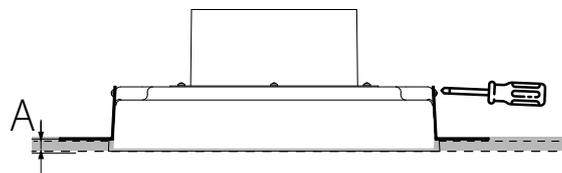
Entfernen Sie die an den Magnethaltern befestigte Frontplatte.
