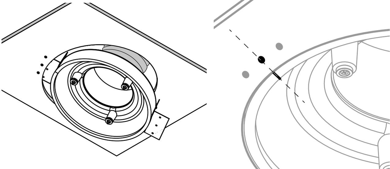
Montieren Sie den Diffusor in das Loch in der Decke. Die Montagehalterungen müssen mit der Rückseite der Trockenbauwand abgestützt werden. Richten Sie die Markierung auf dem Diffusor mit der Mitte des Lochs in der Mitte aus.
