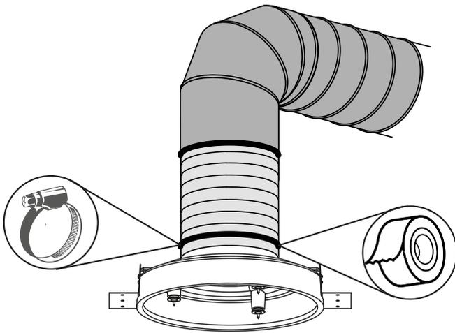
Befestigen Sie die Verbindung mit der Schneckengewindeschelle.
