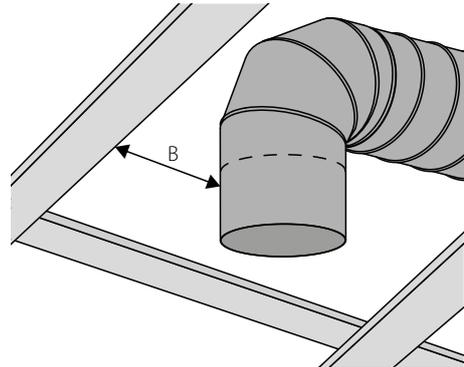
**WARNUNG!** Um Vibrationen zu vermeiden, muss zwischen dem Diffusor und dem starren Rohr ein Stück flexibles Rohr angebracht werden.
