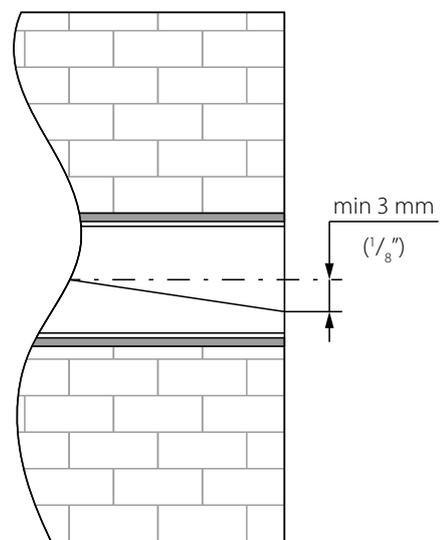
2. Die Dübellöcher zur Montage der Außen-Lüftungshaube mit Hilfe der Rückseite der Lüftungshaube an der Außenwand markieren und vier Löcher  $\varnothing 50$  mm für die Dübel (6 x 40) bohren.
