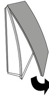
4. Befestigen Sie die Rückseite und den Kondensatabtropfplatte der Lüftungshaube an der Wand mit Hilfe der gelieferten Schrauben 4 x 40.
