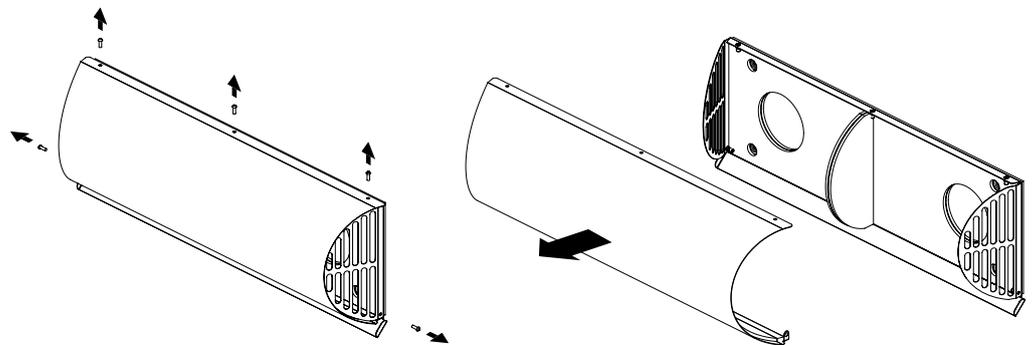
Markieren Sie die Löcher mit Hilfe der Rückseite der Haube. Bohren Sie die 4 Dübellöcher.
