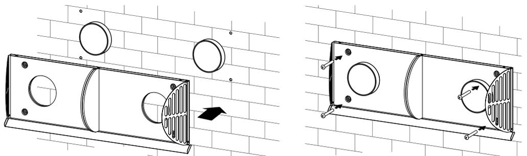
Setzen Sie die Abdeckung der Haube ein und befestigen Sie sie mit Schrauben.
