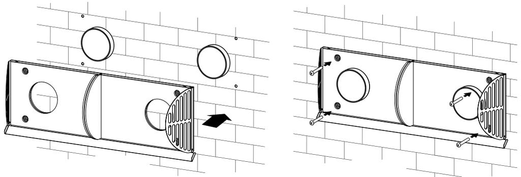
5. Setzen Sie die Abdeckung der Haube auf die Rückseite und schrauben Sie sie an.
