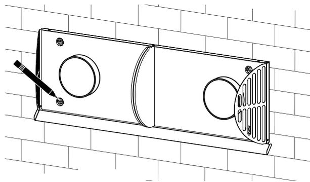
4. Setzen Sie die mitgelieferten Dübel (6 x 40) in die Löcher ein. Befestigen Sie die Rückseite der Lüftungshaube mit den mitgelieferten Schrauben (4 x 40) an der Wand.
