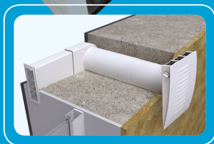
Wand-Unterputzmontage mit Hilfe des Winkelmontagesatzes NP
