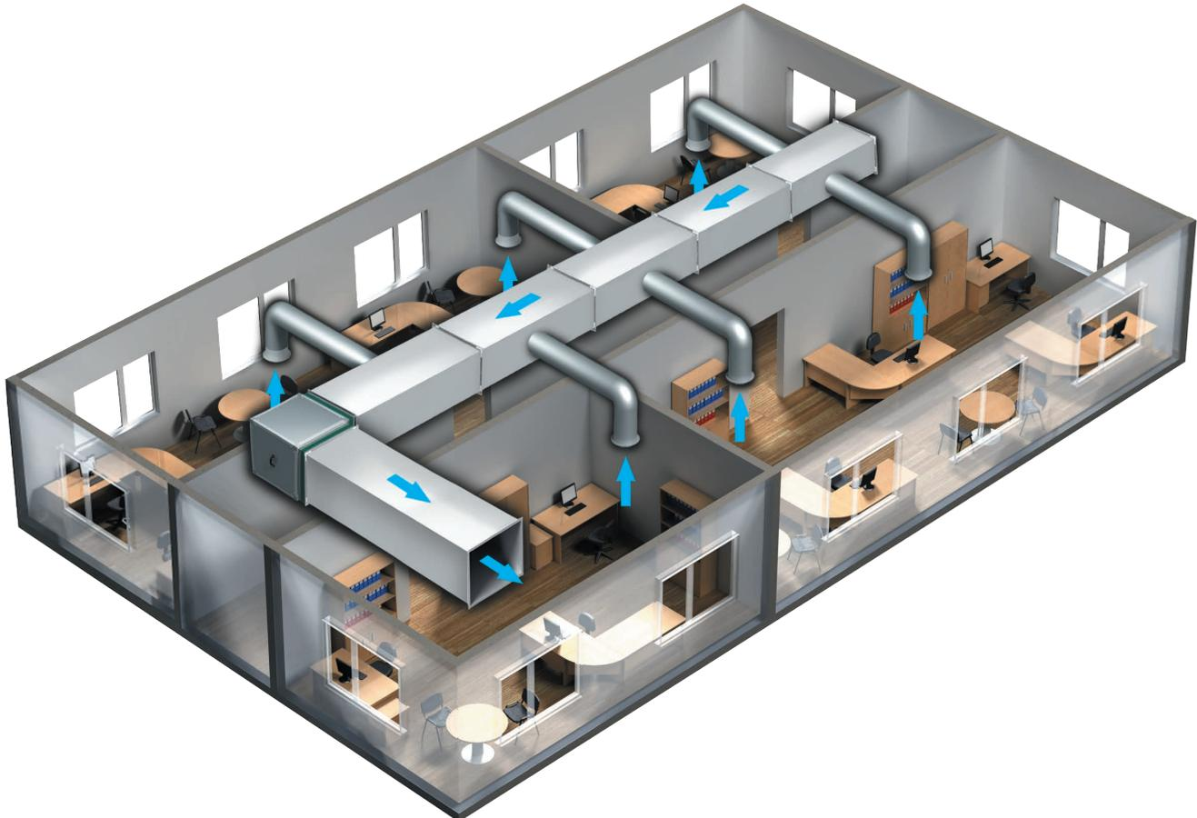
Einsatzbeispiel von Ventilator VS EC im Büro
