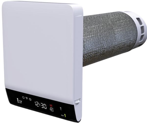
Hocheffiziente Einzelraum-HRV-Geräte mit Keramik-Wärmetauscher, zusätzlichen Luftqualitätssensoren und intelligenter Steuerung über eine mobile App
