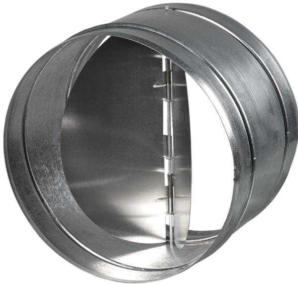
Die Rückschlagklappe mit federbelasteten Platten ist zur Absperrung des Lüftungsröhres und zur Verhinderung von Lufrückstrom bei abgeschaltetem Lüftungssystem bestimmt
