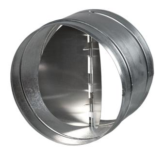
Die Rückschlagklappe mit federbelasteten Platten ist zur Absperrung des Lüftungsrohres und zur Verhinderung von Luftrückstrom bei abgeschaltetem Lüftungssystem bestimmt
