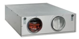
Hängende Lüftungsanlagen mit einem Enthalpie-Gegenstrom-Wärmetauscher aus Polystyrol
