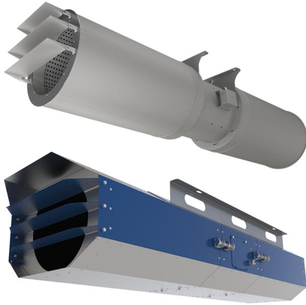
Axial-Strahlventilatoren zur Belüftung von überdachten Parkplätzen. Fördermittelttemperaturen: im Dauerbetrieb bis +55 °C im Entrauchungsbetrieb: 300-400 °C - 2 Stunden. Funktionalität. Leistung. Effizienz.
