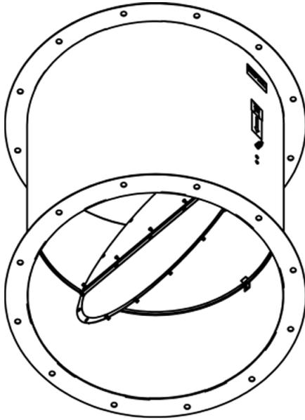
Die Rückschlagklappe mit einer selbsttätigen Luftklappe dient dazu, den Luftstrom in Lüftungsrohre abzusperren und Luftbewegungen in die entgegengesetzte Richtung bei Stillstand des Lüftungssystems zu verhindern
