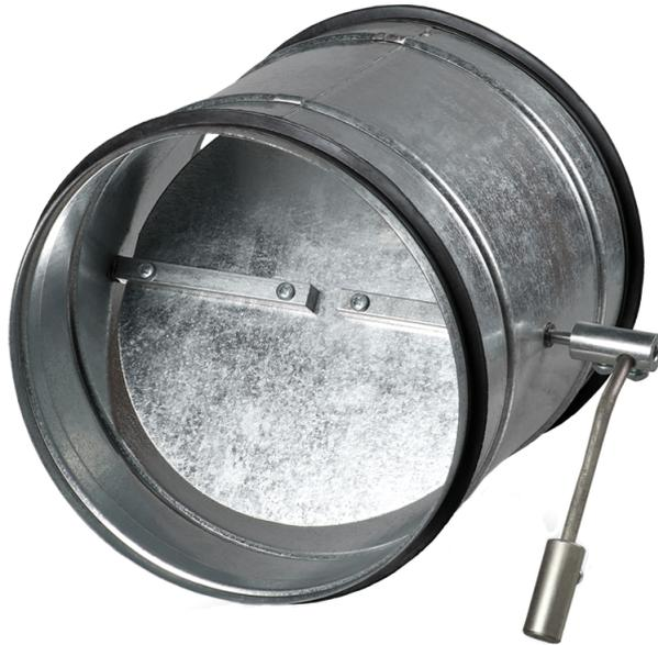
Die selbsttätige Rückschlagklappe ist zur Absperrung der Lüftungsrohre und zur Verhinderung von Luftrückstrom beim Ventilatorstillstand bestimmt
