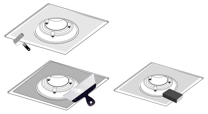
Apply the primer ("Knauf Tiefengrund" or similar). When dry, putty ("Knauf Fugenfüller" or similar) and grind on the surface.
