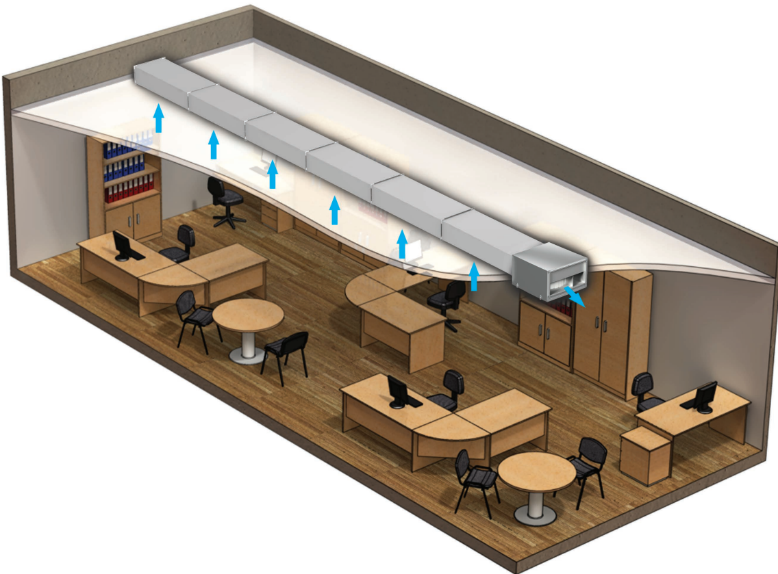
VKPF1 fan office ventilation example
