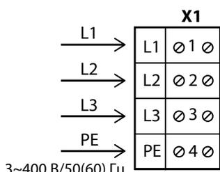
**Схема подключения односкоростного вентилятора**
