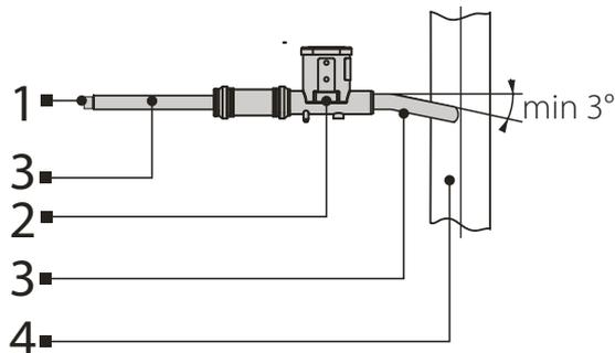
1 — дренажный патрубок установки; 2 — сифон; 3 — труба соединительная; 4 — канализационная система.
