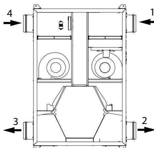
1 — приточный воздух с улицы; 2 — вытяжной воздух на улицу; 3 — приточный воздух в помещение; 4 — вытяжной воздух из помещения.
