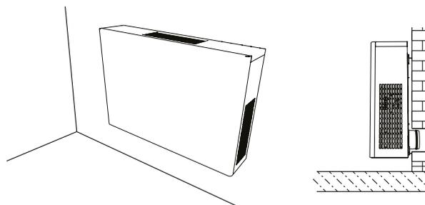
Вертикальный монтаж на наружную стену
