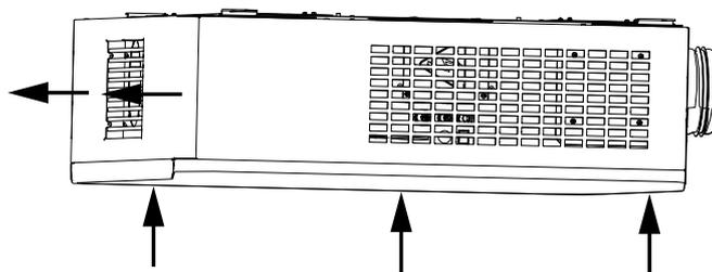
Конструкция установок позволяет менять направление воздухопроводов.
