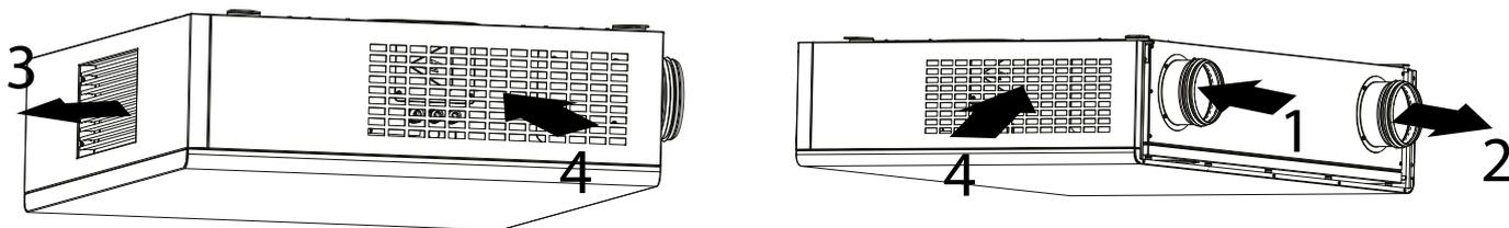
1 — приточный воздух с улицы; 2 — вытяжной воздух на улицу; 3 — приточный воздух в помещение; 4 — вытяжной воздух из помещения.
