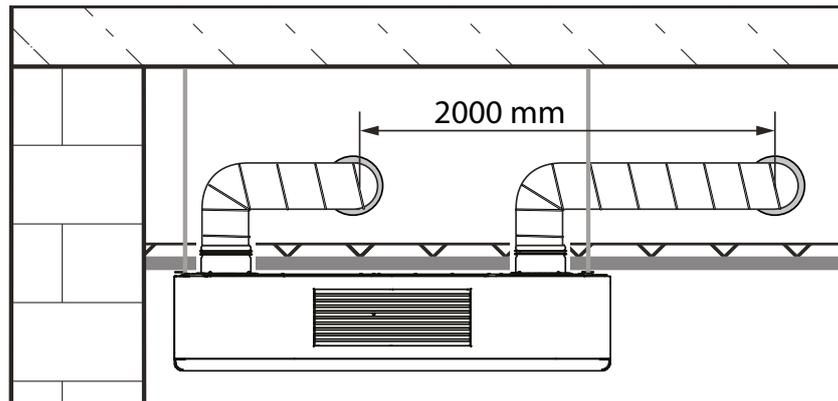
Монтаж к несущему перекрытию. Патрубки проходят через наружную стену
