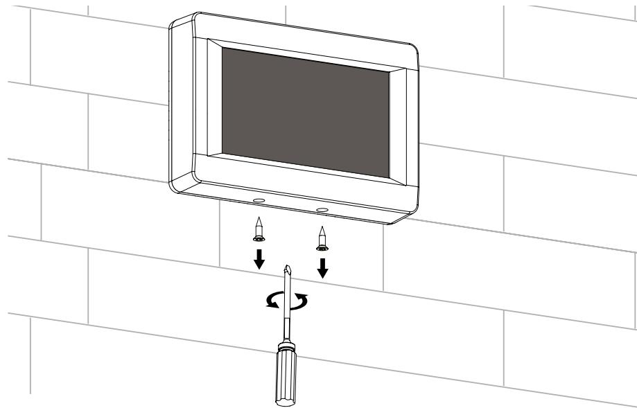
3. Отведите верхнюю часть корпуса в сторону для свободного доступа к верхней плате. Замените элемент питания. В панели используется литиевый элемент питания **CR1220**.
