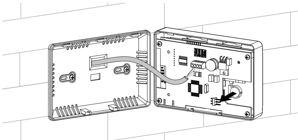
4. Соберите панель в обратном порядке. Если провода клеммника на верхней плате панели управления были отсоединены, соблюдайте правильность их подключения. Неправильное подключение этих проводов может привести к выходу оборудования из строя.
