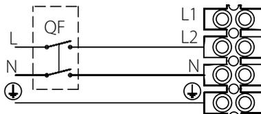
Схема подключения для работы на приток
