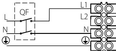
Схема подключения с переключателем режимов работы
