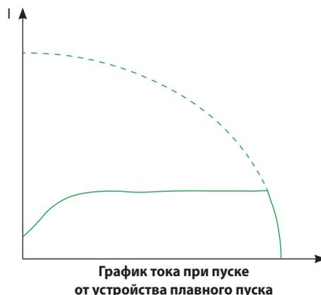
График тока при пуске от устройства плавного пуска
