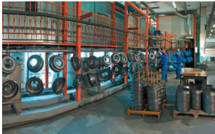
Цех порошковой покраски
