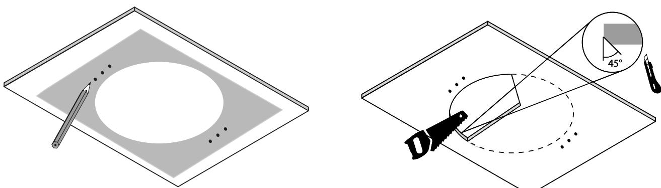
Приложите шаблон к потолку и разметьте место установки диффузора и места крепежных отверстий. Проделайте отверстие в гипсокартоне. Снимите фаску под углом  $45^{\circ}$  на  $1/3$  толщины гипсокартона.
