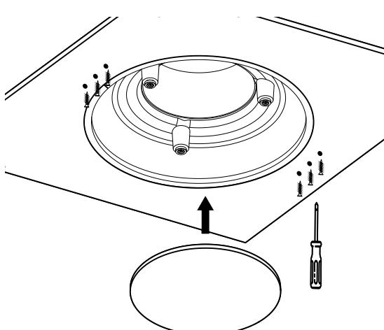
Закрепите диффузор шурупами. Установите лицевую панель на магнитных держателях.
