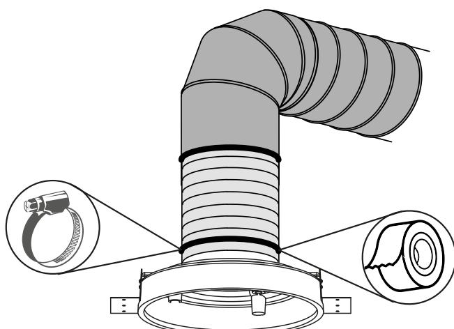
Зафиксируйте соединение червячным хомутом или клейкой лентой.
