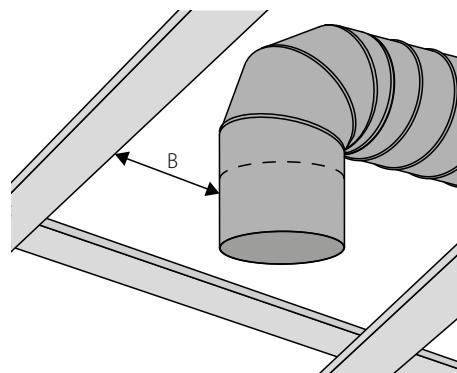
**ВНИМАНИЕ!** Для предотвращения вибрации между диффузором и жёстким каналом необходимо установить участок гибкого воздуховода.
