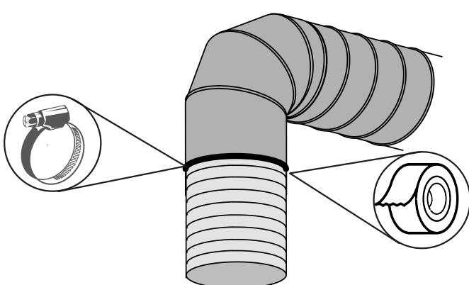
Подсоедините гибкий воздуховод к жесткому каналу. Зафиксируйте соединение червячным хомутом или клейкой лентой.
