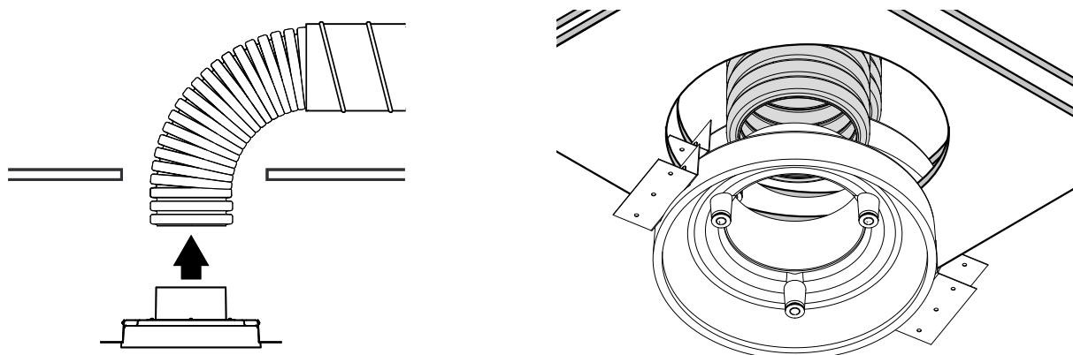
Смонтируйте воздуховод на фланец диффузора.
