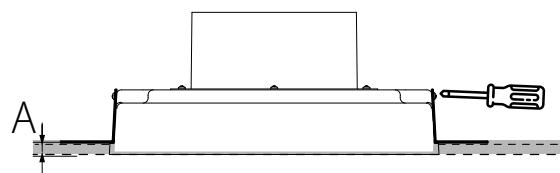
Снимите лицевую панель, закрепленную на магнитных держателях.
