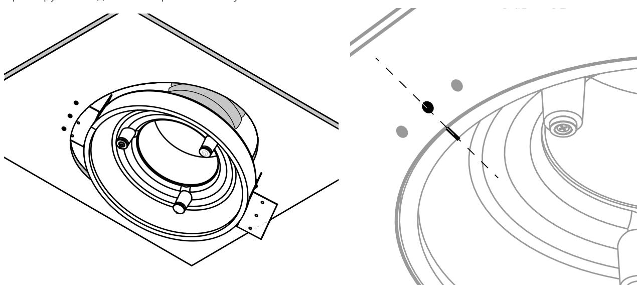
Ведите диффузор в отверстие в потолке и установите его так, чтобы кронштейны опирались на тыльную сторону гипсокартона.
