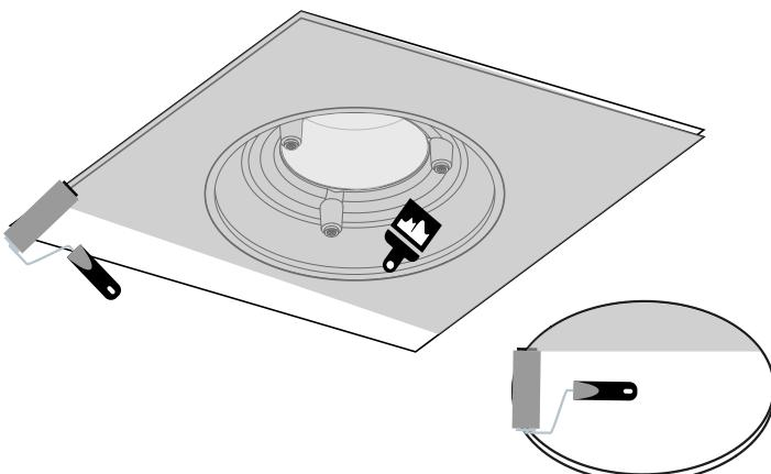
Нанесите грунтовку (рекомендованную производителем краски). Покрасьте диффузор и гипсокартон.
