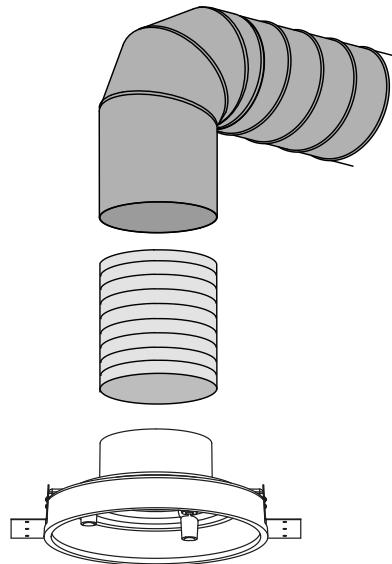
**Для крепления кронштейнов к гипсокартону используйте саморезы не менее Ø 3,9 мм.**
