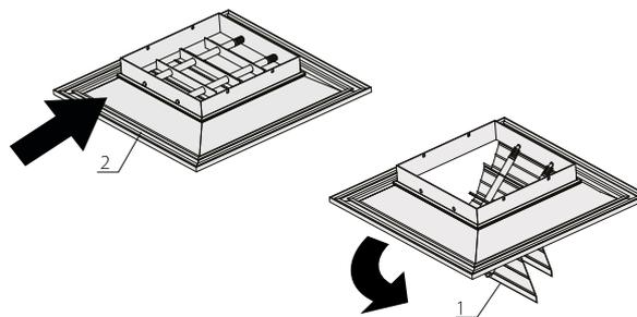
Внешнюю рамку диффузора ДП (позиция 2) установить на реечный каркас изнутри на краях Т-образного профиля. Пленум-бокс (позиция 3), закрепленный на шпильках (позиция 4), подвести ко внешней рамке диффузора (позиция 2). Подсоединить пленум-бокс ко внешней рамке диффузора ДП. Промежутки между внешней рамкой ДП и пленум-боксом не допускаются.
