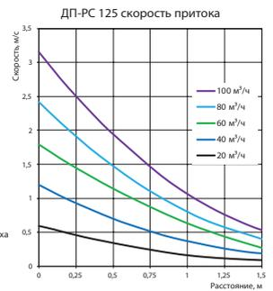
\* Данные предоставляются для диффузора, оборудованного регулятором расхода воздуха Ф4 125 ФБ
