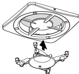
8. При необходимости регулировки воздушного потока установите в диффузор дроссель (регулятор потока воздуха), вынимая из него вставки до получения необходимого воздушного потока (только для Ф4 125 ФБР; для Ф4 125 ФБ дроссель не входит в комплект поставки, заказывается отдельно).
