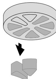
10. После регулировки потока воздуха с помощью дросселя установите решетку с декоративной панелью в обратном порядке.
