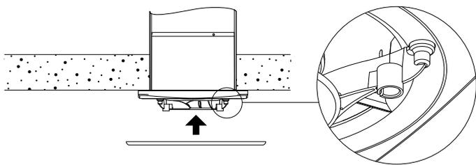
9. Для установки дросселя выкрутите винт фиксации лицевой панели и снимите декоративную панель вместе с лицевой решеткой поворотом против часовой стрелки для расцепления байонетного соединения.
