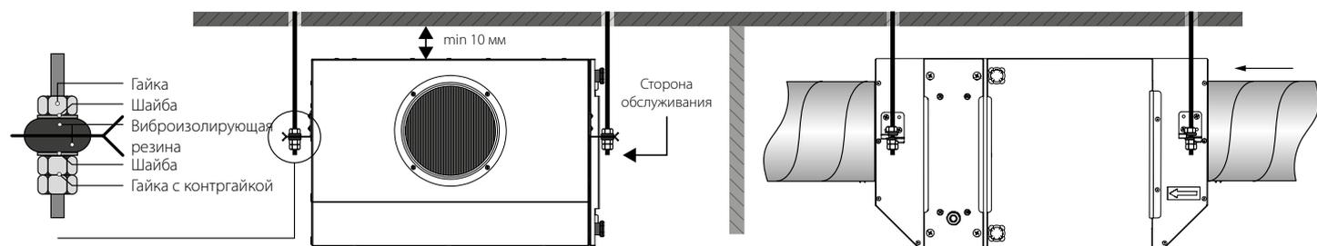
Для обеспечения оптимальной производительности вентиляционной системы и уменьшения аэродинамических потерь, связанных с турбулентностью воздушного потока, присоедините прямой участок воздуховода к патрубкам с обеих сторон изделия. Минимальная рекомендуемая длина прямых участков:
