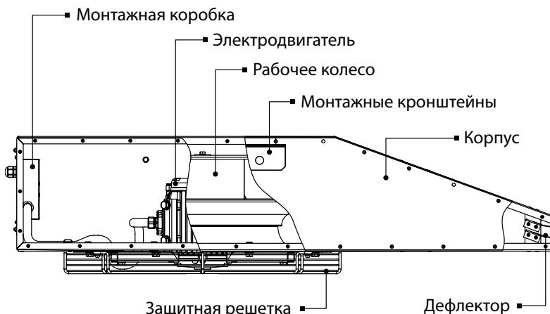
Корпус вентилятора изготовлен из стали с полимерным покрытием. Со стороны всасывания вентилятора установлена защитная решетка для предотвращения попадания посторонних предметов. Со стороны нагнетания вентилятора установлен дефлектор для правильного распределения потока воздуха и усиления тяги.
