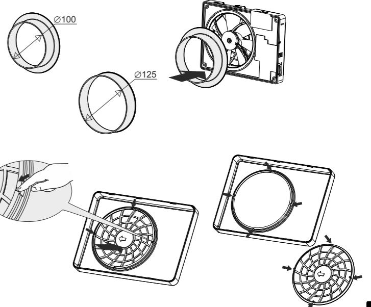
Вентилятор комплектуется съемной решеткой. Для того, чтобы снять решетку с лицевой крышки, аккуратно нажмите на защелки. При установке решетки на лицевую крышку необходимо, чтобы защелки попали в соответствующие пазы в крышке. Стрелка на обратной стороне решетки должна быть направлена на ближнюю к отверстию короткую сторону.
