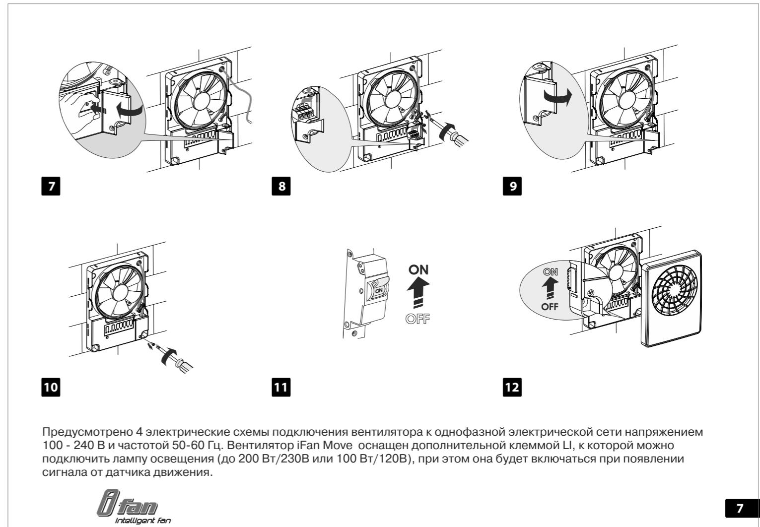
Предусмотрено 4 электрические схемы подключения вентилятора к однофазной электрической сети напряжением 100 - 240 В и частотой 50-60 Гц. Вентилятор iFan Move оснащен дополнительной клеммой L1, к которой можно подключить лампу освещения (до 200 Вт/230В или 100 Вт/120В), при этом она будет включаться при появлении сигнала от датчика движения.
