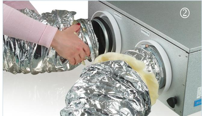
Наденьте внутренние рукава теплоизолированных воздуховодов на патрубки вентиляционной установки и закрепите их с помощью металлических хомутов (приобретаются отдельно).
